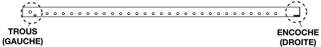
1. Avec la porte de l'appareil ouvert ou enlevé, insérez le côté gauche du tuyau d'air secondaire dans le trou dans **le côté gauche** de l'appareil.
